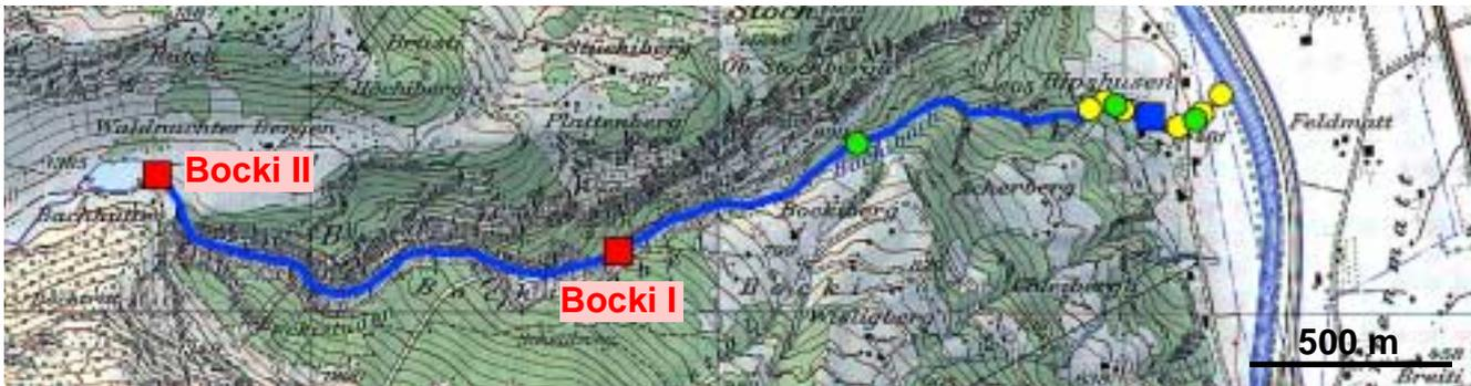
Bockibach mit Wasserfassungen, Restwasserstrecke, Wasserrückgabestelle sowie Abfischungsstrecken und allgemeinen Untersuchungsstellen. Nur die untere Restwasserstrecke (Bocki I) wurde untersucht. Reproduziert mit Bewilligung von swisstopo (BA035367).
