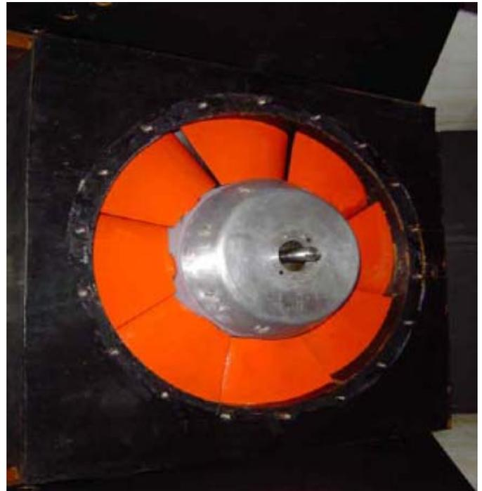
**Abbildung 12: VHL Turbine - Ansicht von unten aus Leclerc, M. (2006)**
