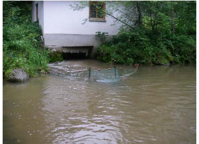
**Abbildung 25: Schüttentobel - Fangstelle unterhalb der Turbine - Flügelreue zweikehlig mit Haus (10mm Maschenweite im Fangsack).**
