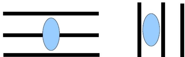
**Abbildung 3: Wirkungsweise Horizontal- und Vertikalrechen**
