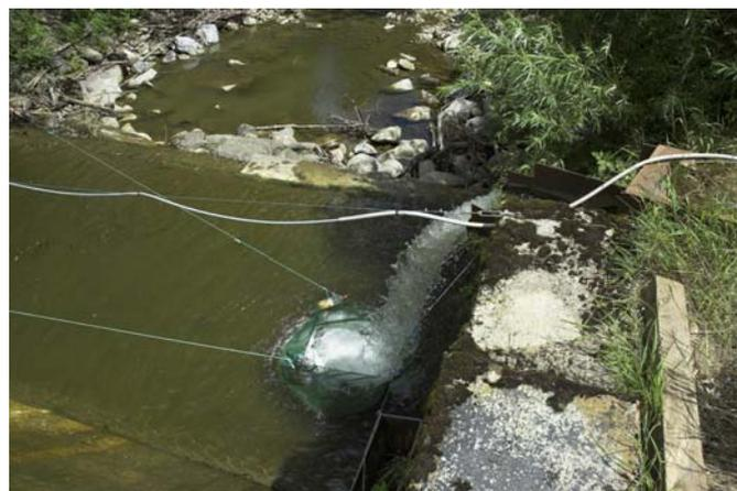
**Abbildung 45: Aufstecknetz als Fangkorb unter dem Auslauf einer Spülrinne**
