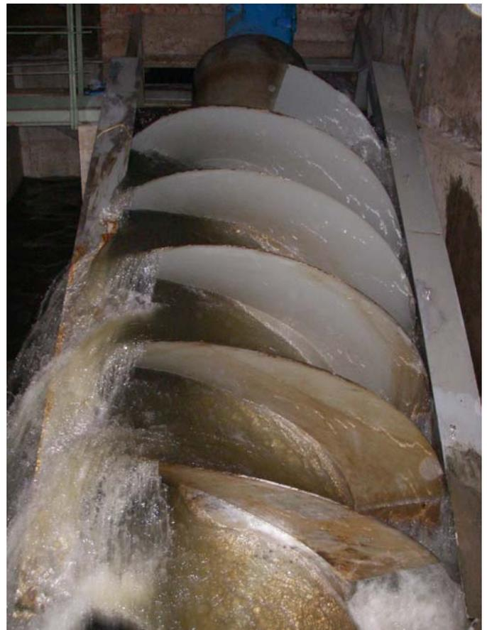
**Abbildung 9: Schneckenturbine in der mittelfränkischen Gugelmühle.**
