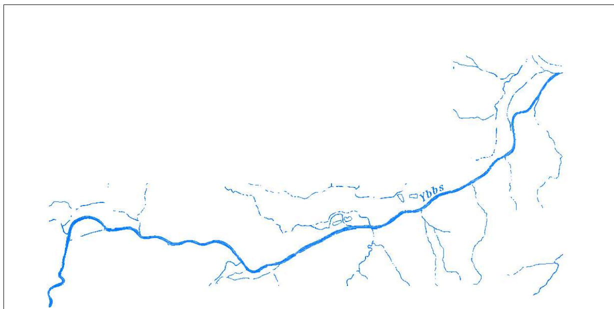
Abbildung 2: Derzeitiger Unterlauf der Ybbs im Bereich Amstetten bis zur Mündung Donau. Der ehemals furkierende Verlauf (siehe Anhang) wurde im Zuge des Flußbaues stark begradigt und gestreckt.
